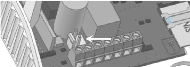
Connectez ici le cordon fourni et branchez dessus une batterie afin de rechercher le meilleur emplacement pour votre SWITCH'GSM.
